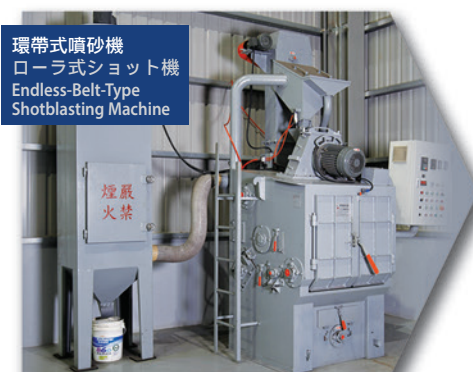
噴砂 ショット Sand Blasting
