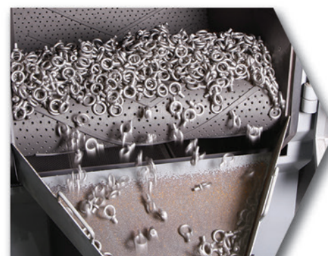
噴砂 ショット Sand Blasting
