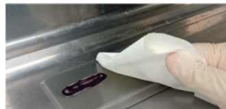
しばらく放置し紫色に反応したら 水で洗い流す。またはクロスで拭 いたあと水で流すか水拭きする
