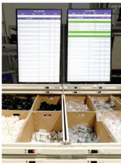
1 デジタル ピッキングシステム ミスのない物流管理
