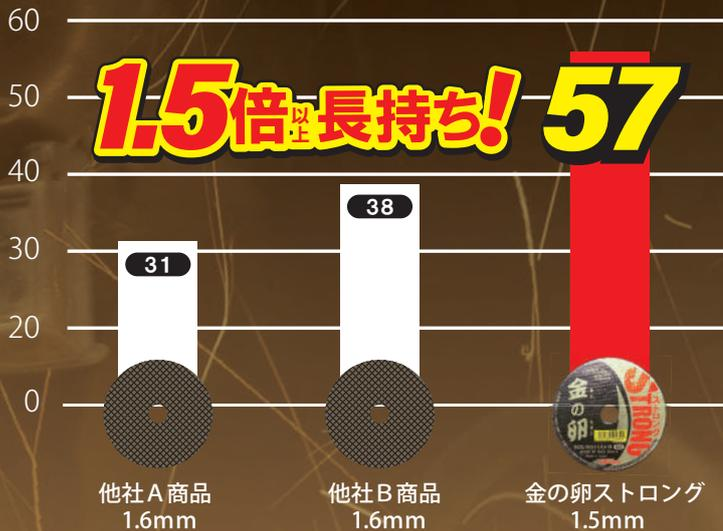
当社比：自動切断機を使用し、他社切断砥石Φ105と比較。部材：SUSΦ13丸棒を同荷重で切断した場合。
