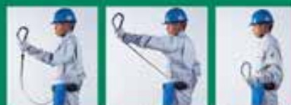
縄ロープを引き出し 位置で止めて作業
